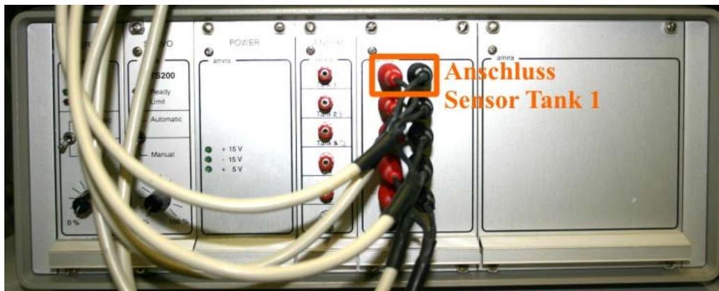
**Bild 3: Anschlüsse des Dreitanks**
